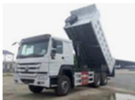
Suivant son utilisation, les équipements dont il dispose peuvent être très variés. Il peut être doté d'une à trois bennes ainsi que d'une grue auxiliaire. Il est généralement utilisé pour transporter des matériaux en vrac (sable, terre, gravier, gravats,...).
