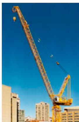
Les grues se différencient par le système de montage : par éléments (grue à flèche relevable, à tirants ou sans tirants, par ex.) ou automatisé (grue à montage rapide).
